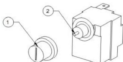
Questo allarme si presenta quando il termostato di sicurezza interviene a causa di elevata temperatura all'interno della stufa.
