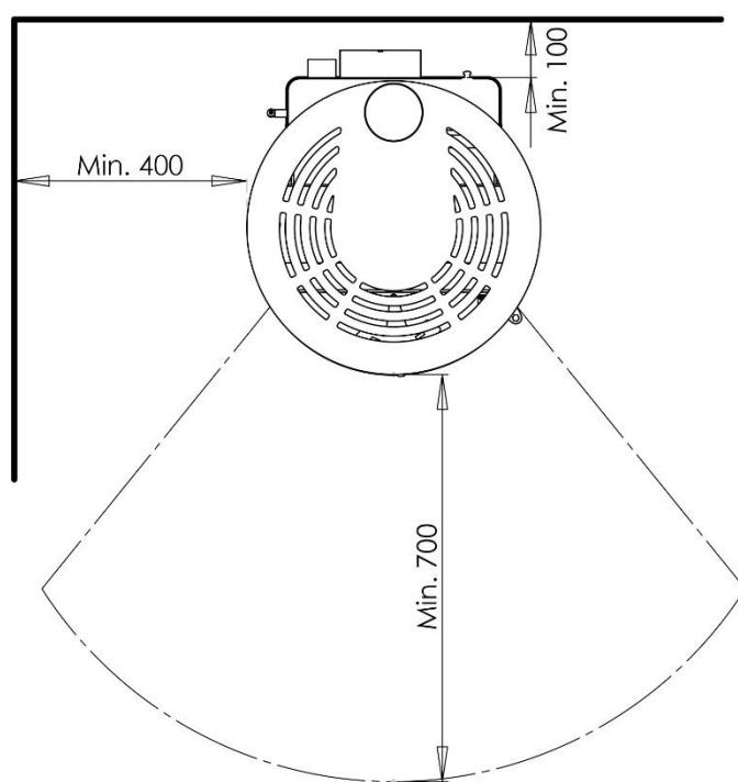
Per garantire un facile accesso e sufficiente aria per la combustione, è importante lasciare uno spazio non inferiore agli 10 cm tra il retro della stufa ed il muro dietro di essa e 40 cm ai lati. Sarà inoltre necessario smontare il raccordo della canna fumaria e ruotare la stufa durante l'ispezione annuale e le operazioni di manutenzione.
