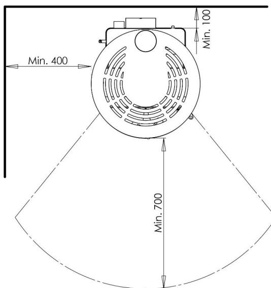
For at sikre adgang til inspektionsåbninger og luft til forbrændingen skal der altid være minimum 10 cm afstand til væggen bagud og 40 cm til siden. Man må dog være forberedt på at afmontere røgrør og dreje ovnen ved det årlige serviceeftersyn og ved vedligeholdelse.
